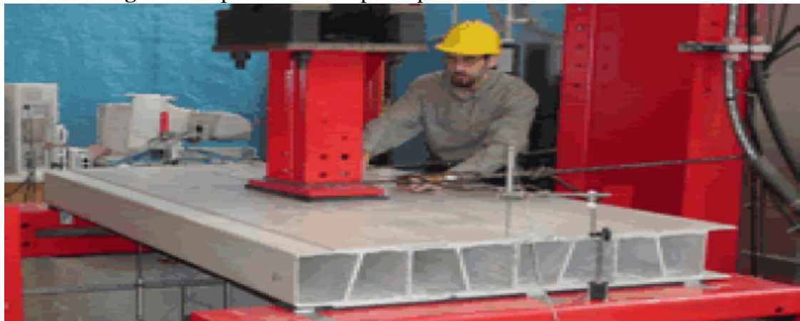
Figure I-6 : pont routier de petite portée entièrement fait de PRF
